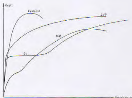
Bild 1: Arbeitslinien verschiedener Verbindungsarten
